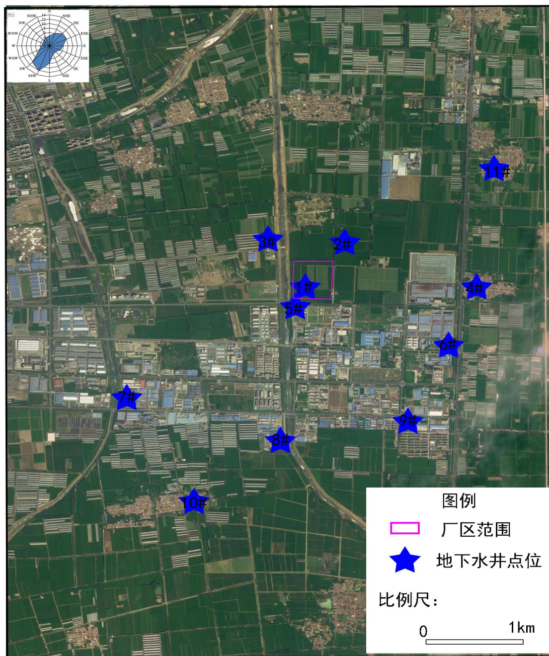
图 3.4-1 地下水现状监测布点图
